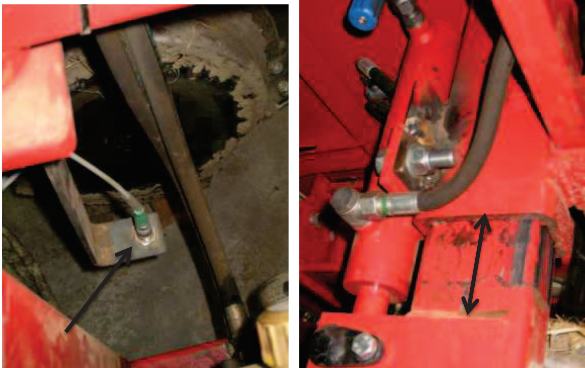
Figuur 13: Ultrasoon sensor voor hoogte bepaling (links) en hydraulische cilinder voor hoogteregeling (rechts)
