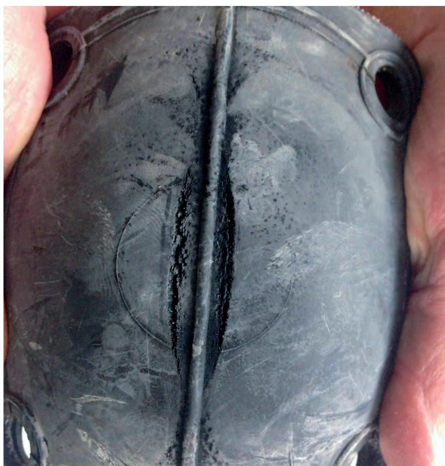
Voorbeeld van een membraan dat na zes weken productie al begon te scheuren.
