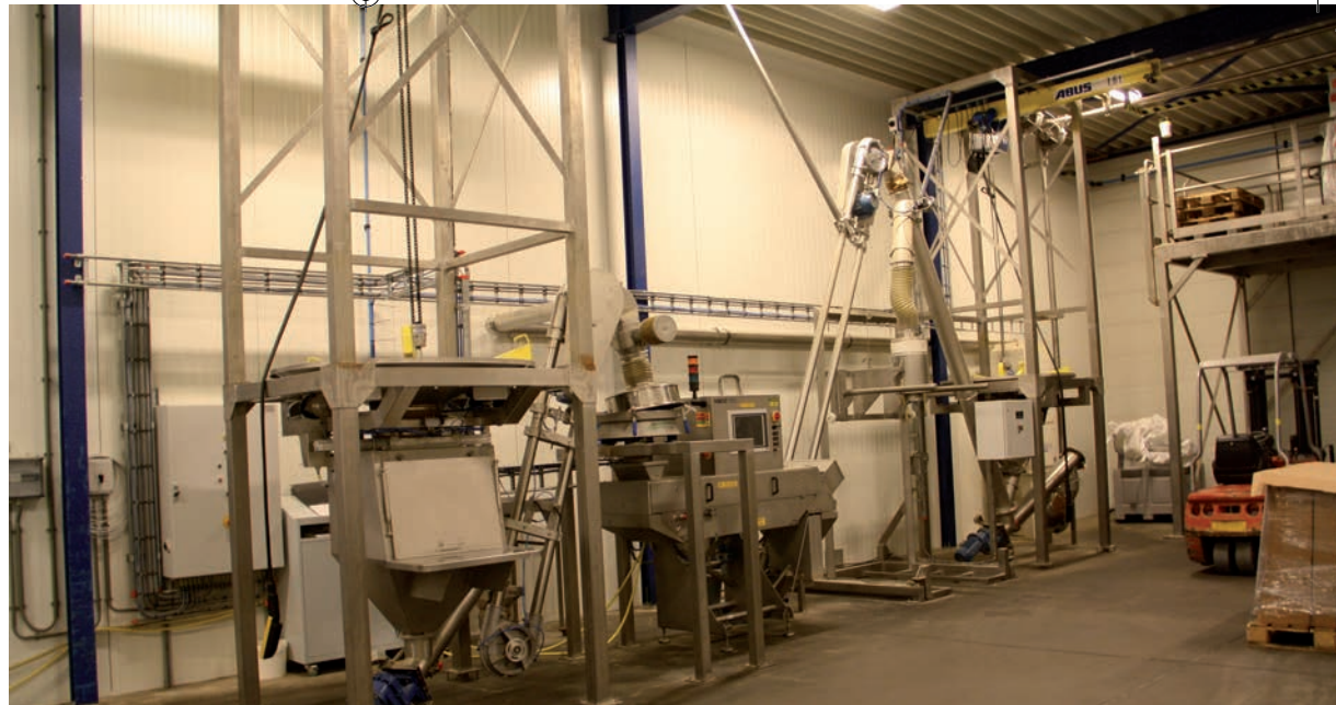
Lasercontrole van rozijnen. Het afval verdwijnt in de blauwe bak.
