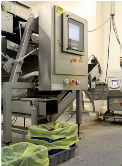
Lasercontrole van rozijnen. Het afval verdwijnt in de blauwe bak.
