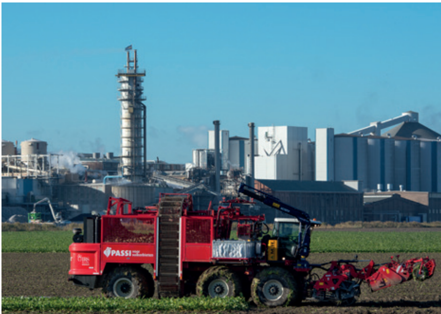
Met PASSI (Plot harvesting And Sampling System IRS) verwacht het IRS weer jaren vooruit te kunnen met de oogst van suikerbietenproefvelden in Nederland.
