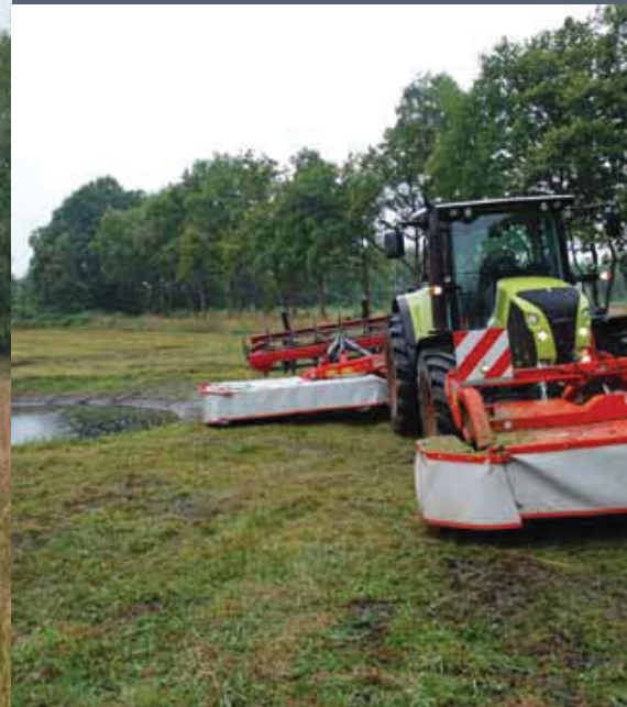
Links: de maai-harkcombi van achteren met duidelijk de harkbreedte en de wiers die tussen de achterwielen van de trekker uitkomt. Op de achtergrond de opraap- en doseerwagen.
