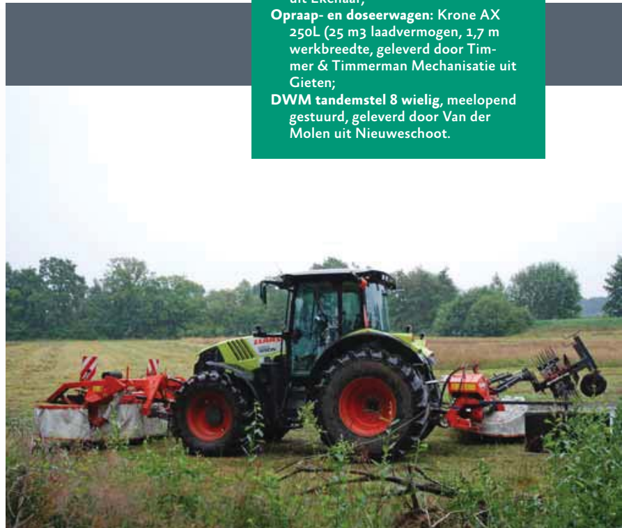
Boven: zij aanzicht van de maai-harkcombinatie met de frontmaaier, de achtermaaier en daaraan bevestigd de (hier omhoog getilde) harkunit.
