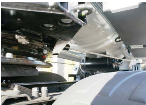
◀ De tank is zelfdragend. De voorste en achterste assen zijn mechanisch gedwongen gestuurd via twee van deze staalkabels in combinatie met een stuurstang tussen de voorste en de achterste as.
