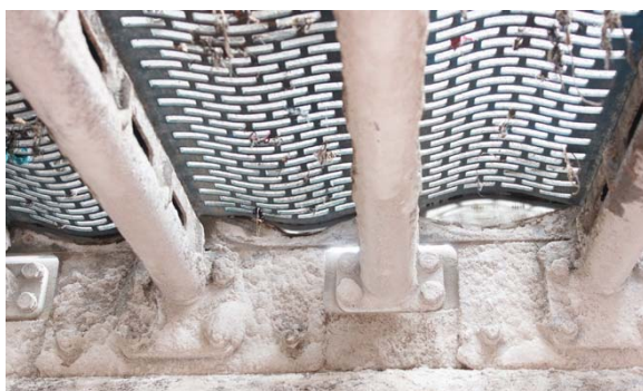
◀ Het geheim: de linkerbalk zit vast aan de zeefbox, de rechter zit in het subframe dat in de rubberen blokken hangt.
