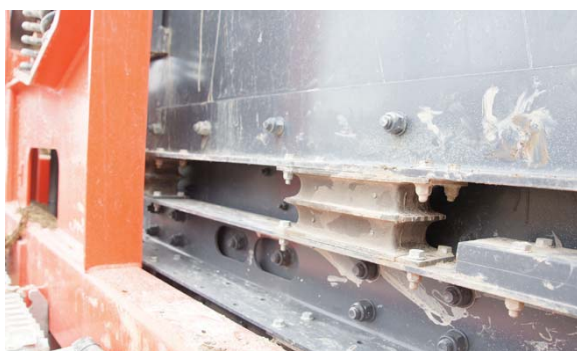
◀ Het losse deel van de zeefbox hangt in rubber blokken. De moeren op het frame zijn van de U-balken die met dit deel meebewegen. De moeren in de opening zitten vast aan de bovenste box.
