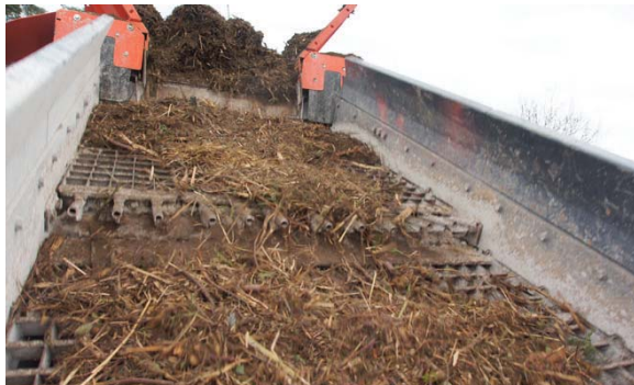
◀ Een extra afdichtingsplaat bij de overgang tussen twee dekken voorkomt ook dat langere delen loodrecht door het eerste dek vallen.
