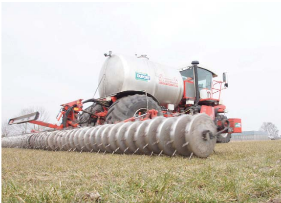
◀ De spaakwielbemester kan zo voor het uitrijden van mineralenconcentraat worden ingezet.
