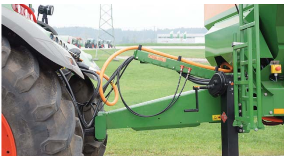
◀ De dikke oranje kabel is voorlopig kenmerkend voor de nieuwe elektrische aandrijving.
