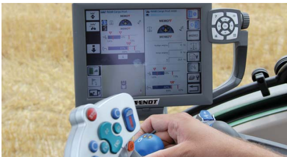
◀ Op het scherm van de Fendt nieuwe gegevens over ampères en voltages van de aandrijving.
