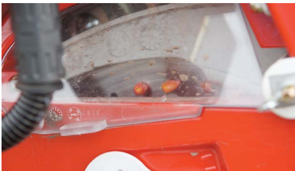
◀ De machine werkt met onderdruk, waarbij de zaaieschijf worden gezogen.
