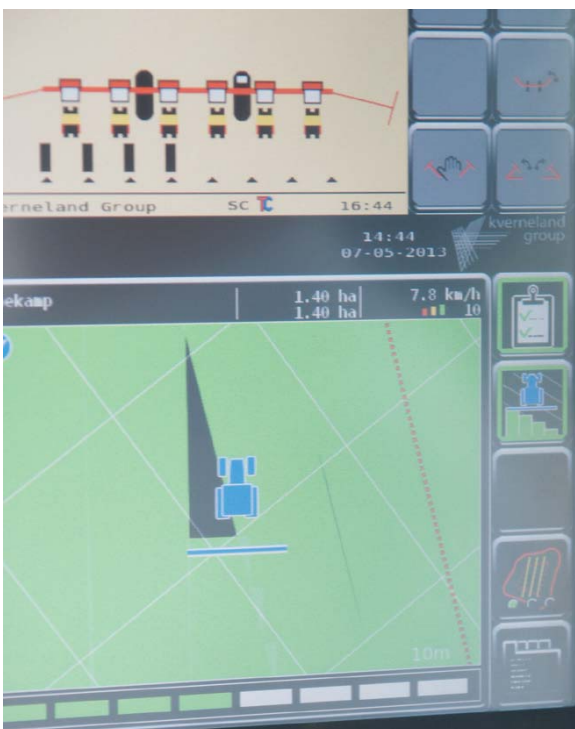
◀ Het Tellus-scherm is op te delen in twee delen. Boven geven de streepjes onder het zaaielement aan dat dit is ingeschakeld. Op het overzicht is te zien wat nog moet worden gezaaid.
