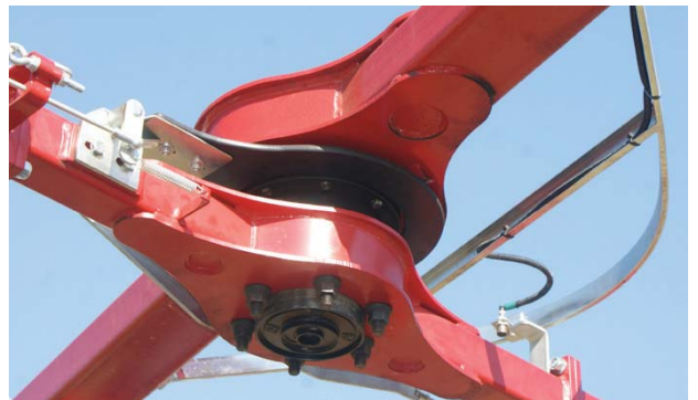
De zwaar uitgevoerde stalen wikkelaararmen worden rechtstreeks aangedreven met wielmotoren.
