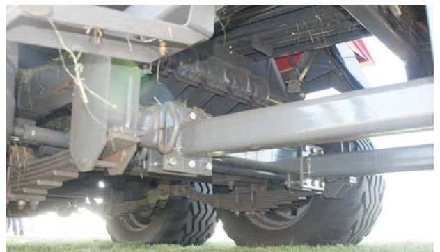
De wikkelaar is met een tussenframe aan de pers gemonteerd. De opleg-druk is circa honderd kilogram.
