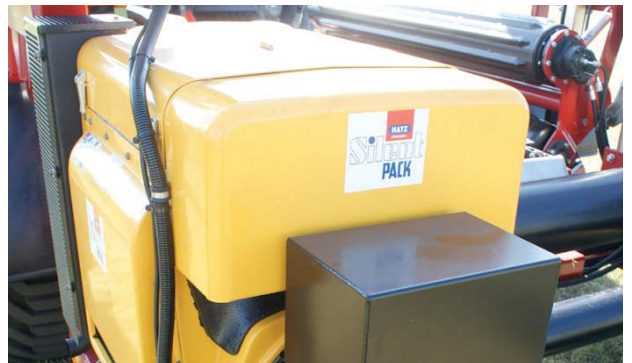
De Tawi heeft een eigen 33 kW (45 pk) Hatz-dieselmotor, die als silent pack-uitvoering is gemonteerd.
