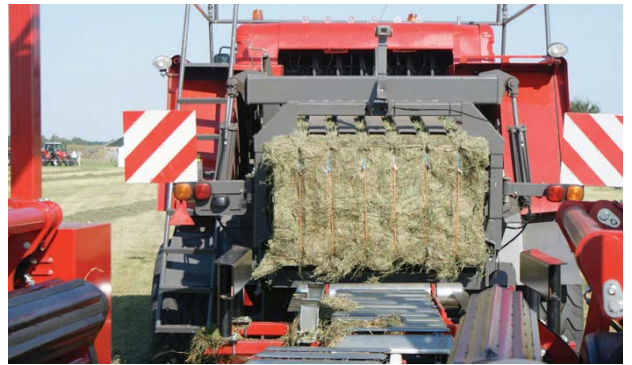
De tussentafel volgt bij wendingen en bochten automatisch de pers, totdat de baal geheel op de tussentafel ligt.
