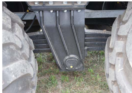
Onderstel met het trekpunt onder het hart van het wiel.
