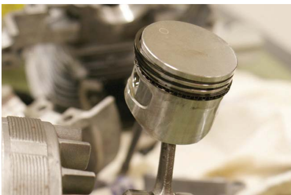
◀ Dat we met viertakttechniek te maken hebben, is goed te zien aan de zuiger met olieschraapveer.
