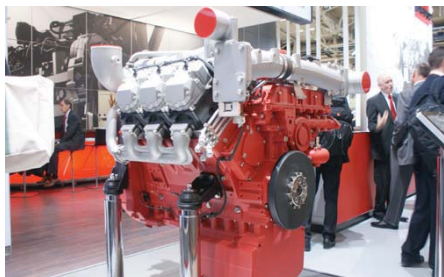
Deutz toonde de 12,0-liter-V6- en 16,0-liter-V8-TCD-motoren met 240 tot 520 kW (322 tot 697 pk) als Stage IIIb en Stage IV. De fabrikant kiest hier voor extra heet en ongecompliceerd, met alleen een dubbele SCR-unit, zonder EGR en zonder roetfilter.
