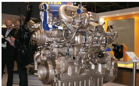
John Deere liet duidelijk de trend zien: bij de lichtste motoren de minste toevoegingen, bij de zwaardere alles erop en eraan. Dus bij John Deere naast EGR en een roetfilter nu ook een SCR-unit (AdBlue).
