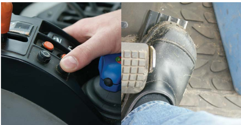
Op DTM rijden is eigenlijk simpel: de DTM-knop activeren, de voet van het gaspedaal en de snelheid bijregelen met de versnellingshendel.
