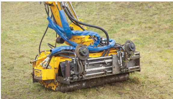
◀ Bij het opklappen schakelt de maaier automatisch uit en omgekeerd in. Let op de geleiderail.
