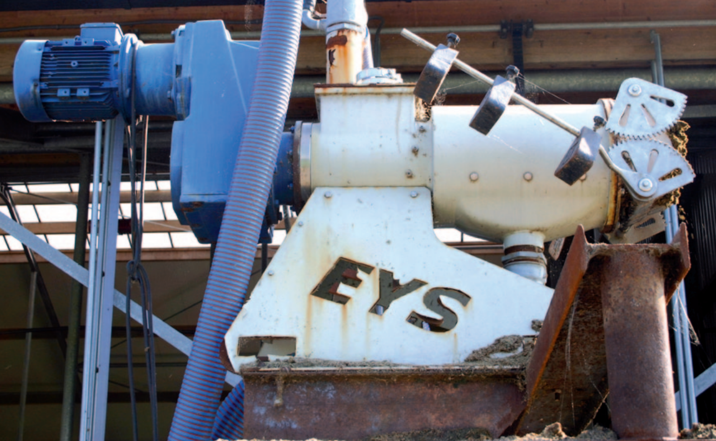
Een elektromotor drijft de Eys SP-mestscheider aan.
