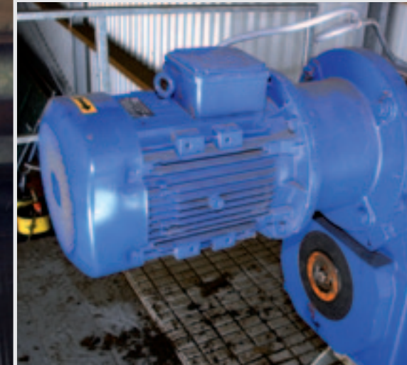
Een elektromotor drijft de Eys SP-mestscheider aan.
