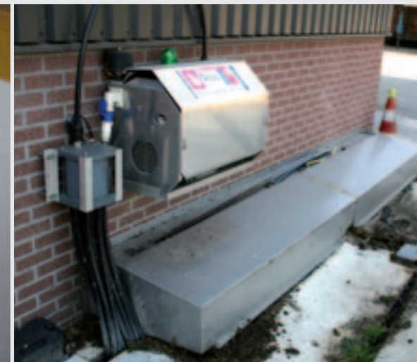
Door lucht in de verzamelde drijfmest te blazen, wordt het mengsel vloeibaarder.
