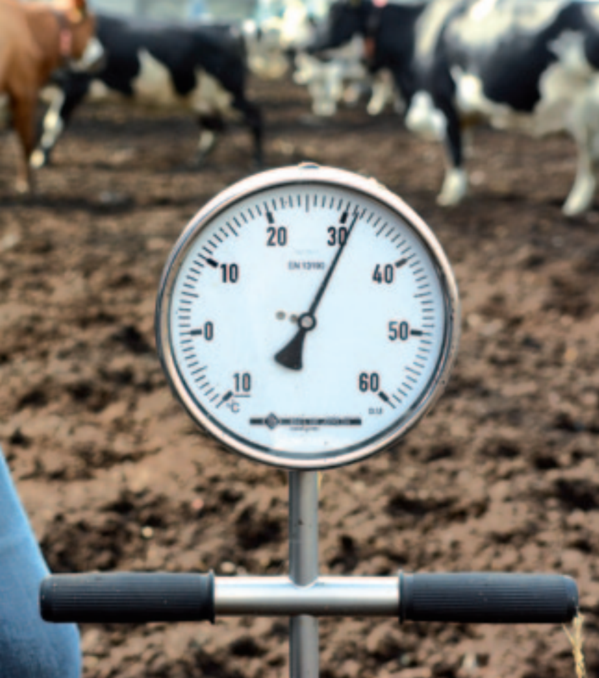
De temperatuur van de strocompost bodem komt niet boven 32 graden Celsius uit. Dat voorkomt warme compostering. Toch is het XTAS-gehalte nog te hoog.
