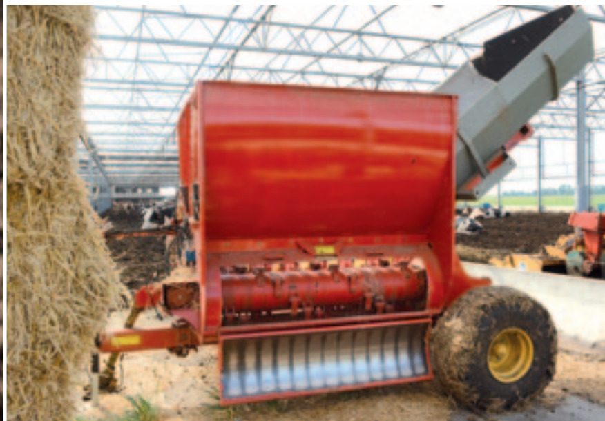
Een geïmporteerde Vermeer BPX9000-balenhakselaar, verdeelt grote pakken stro door de stal. De machine koste 15.000 euro.
