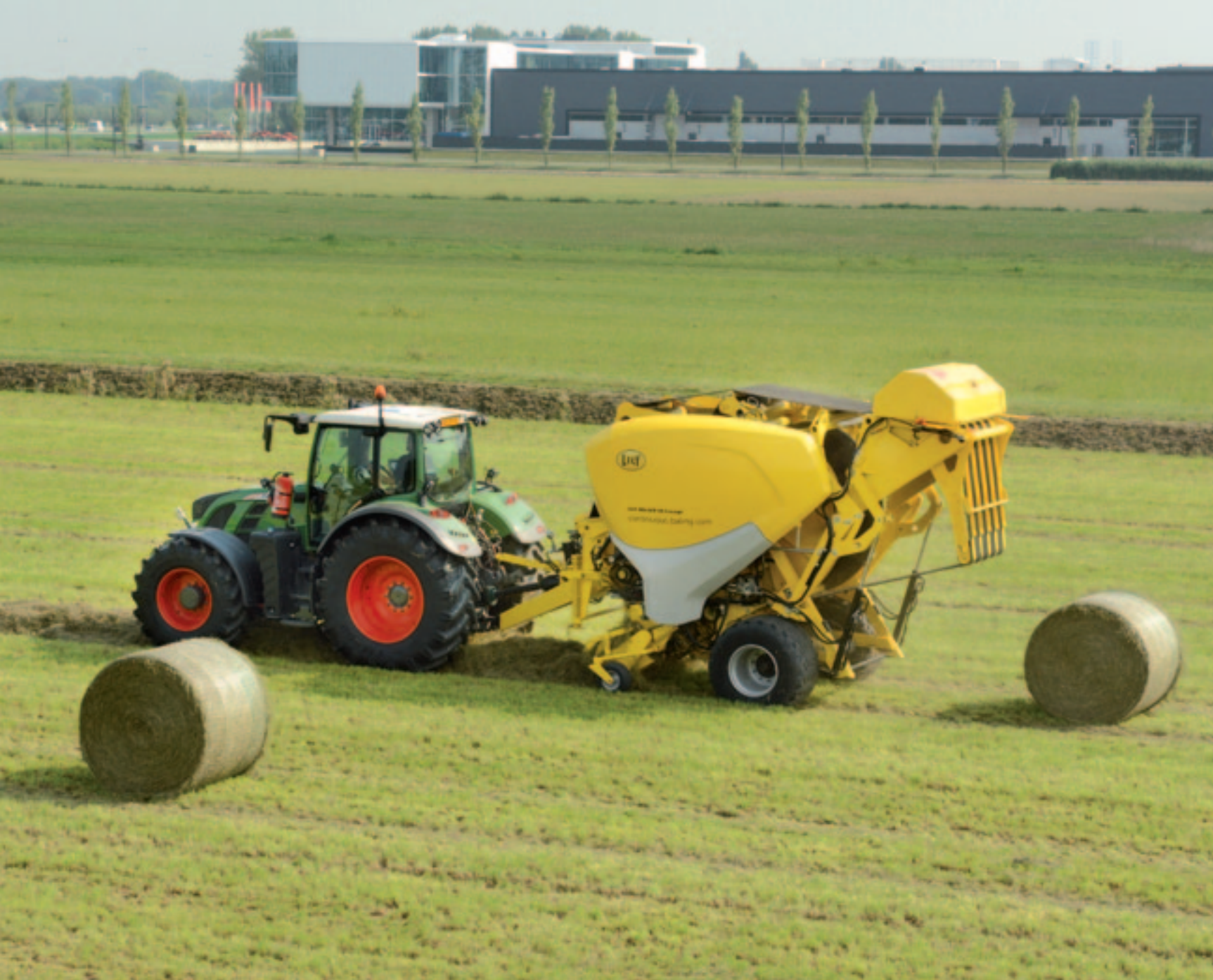
< De pers heeft zijn eigen hydraulisch systeem en vraagt een trekker vanaf 170 pk.
