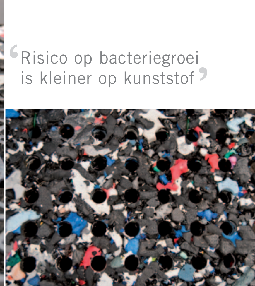
In de foamlaag zijn gaten gestanst die snel de urine afvoeren. De dikke mest blijft liggen en wordt door de robot opgeraapt.
