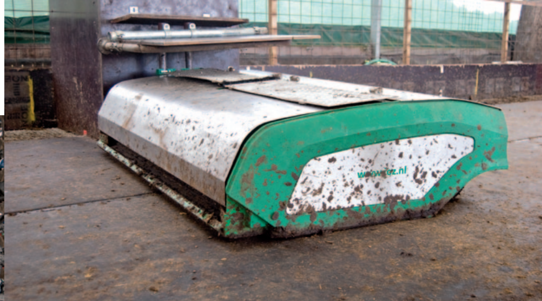
De twee meter brede JOZ-robot in Noords stal is nog een prototype. Het apparaat werkt als een rolbezem. Eerst veegt die de mest op, vervolgens gaat de mest via een bandje naar een bunker, die je later kunt lossen. De robot heeft twee 12-volts accu's. De mest die de robot verzamelt, is doorgaans bijna stapelbaar.
