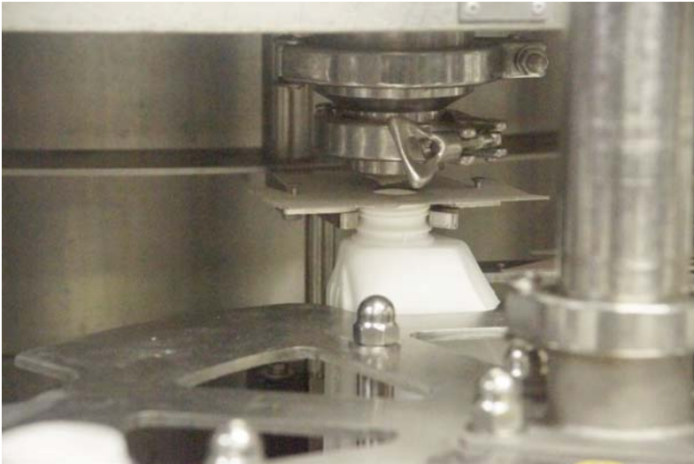
▲ Kwaliteit is alles in de fabriek van Monsanto. Zo zorgt een kartonnen viltje rond de vulopening ervoor dat er geen druppels op de schroefdraad komen. Het voorkomt vervuiling en vastzitten van de dop.
