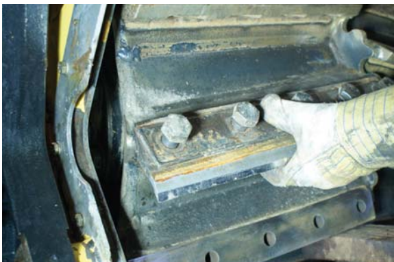
◀ Specialistisch werk, zoals het stellen van messen en tegenmes, doet de Twentrac-monteur. Omdat de maismessen al door Van Herwijnen waren verwijderd, kan hij meteen aan de slag.
