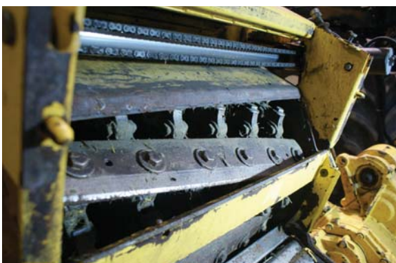
◀ Zo op het oog kunnen deze grasmessen nog wel even mee. Maar volgens de monteur van Twentrac is er te weinig stelruimte om een seizoen te halen. Dus worden ze toch vervangen.
