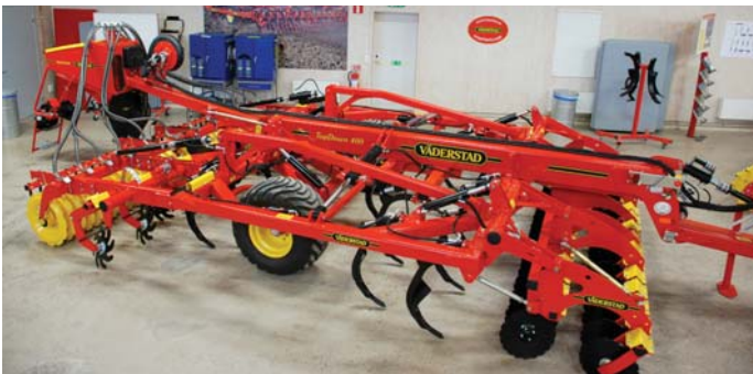
▲ De TopDown van Väderstad kan worden uitgerust met elke gewenste combinatie van schijven of tanden. Per rij is de werkdiepte altijd hydraulisch instelbaar.
