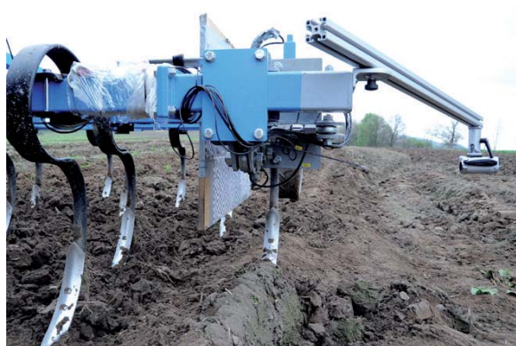
De testcultivator van de universiteit van Dresden registreerde via sensoren aan de koppelpunten en aan de tanden alle optredende krachten en koppels.
