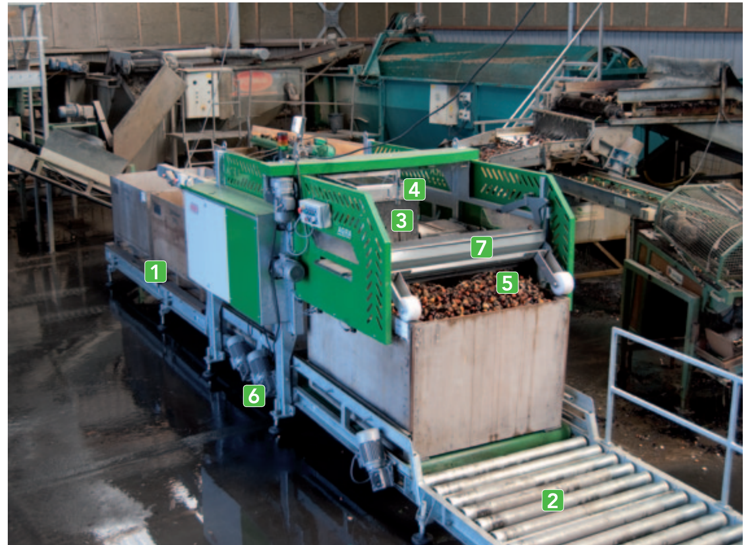
^ Graafstra Agra-kistenvuller De kistenvuller heeft een aanvoerband [1] en een afvoerbaan [2]. De smalle dwarsband [3] beweegt van links naar rechts. De ultrasoonsensor [4] meet de vulling en geeft een signaal als de positie van opvangbord [5], dwarsband of kist moet worden veranderd. Een extra elektromotor [6] zorgt ervoor dat de kist twee kanten op kan bewegen. Een met gasveren gepositioneerd bord [7] zorgt dat het product niet over de rand van de kist rolt.
