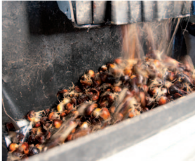
^ Opvangbord Om de kist goed te vullen, bedacht Graafstra een elektrisch bewegend opvangbord. Het beperkt de valhoogte en voorkomt stortkegels in de kist.
