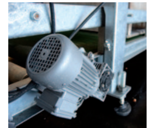
^ Kist heen en weer bewegen Een tweede elektromotor kan de kist tijdens het vullen ook terugtrekken. De smalle vulband beweegt enkel van links naar rechts.
