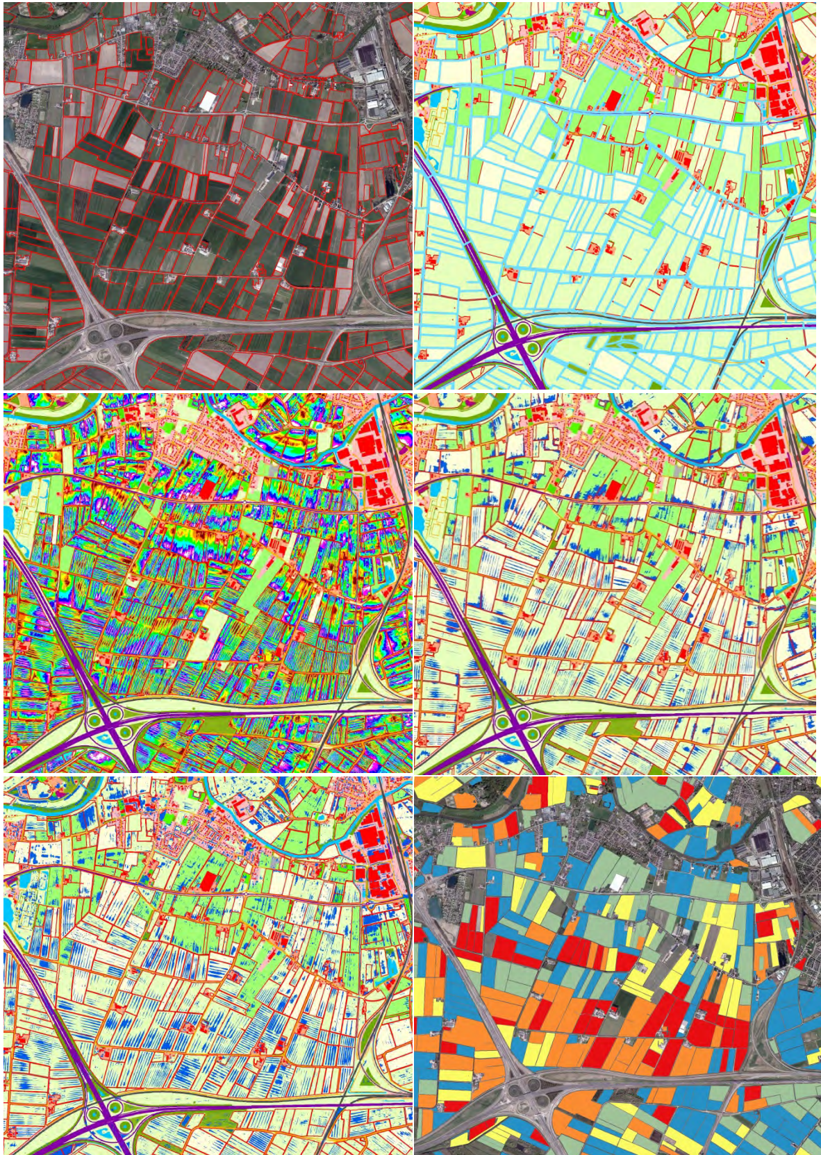
Figuur 5.2 Detail omgeving Deil, luchtfoto met perceelgrenzen (rood) (linksboven), topografie met waterlopen (rechtsboven), berekende percentielen van de maaiveldhoogte (links midden, voor legenda zie Figuur 4.7), 15% lage plekken (rechts midden), maaivelddepressies (linksonder) en gemiddelde maaiveld berging (rechtsonder, voor legenda zie Figuur 4.16)
