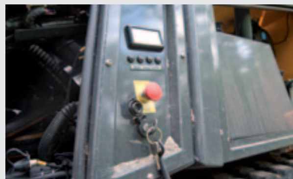
De meeste functies bedien je vanaf de afstandsbediening. De contactsleutel en een dodemansknop vind je op de machine.
