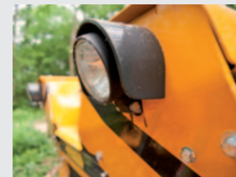
Met twee lampen voor en twee lampen achter kan in het donker gewerkt worden. De afstandsbediening is niet verlicht.
