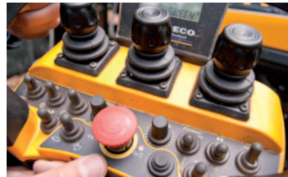
Met de afstandsbediening kan heel veel, alsmede het compleet spiegelen van de bediening. Of je nu het werktuig in de frontthef of achter bedient, het bedienen van de belangrijkste functies (rijrichting, sturen, hydraulische functies) gaat altijd op dezelfde wijze.
