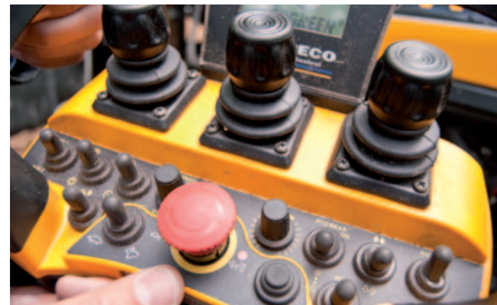
Met de afstandsbediening kan heel veel, alsmede het compleet spiegelen van de bediening. Of je nu het werktuig in de front of achter bedient, het bedienen van de belangrijkste functies (rijrichting, sturen, hydraulische functies) gaat altijd op dezelfde wijze.
