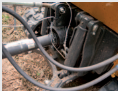
Fabrikant Energgreen ontwikkelde zelf de hefinrichtingen die uit de voeten kan met machines volgens categorie II.
