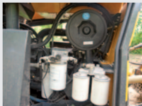
Filters zijn vrij goed bereikbaar na het demonteren van een kap aan de linkerkant van de Robopower.
