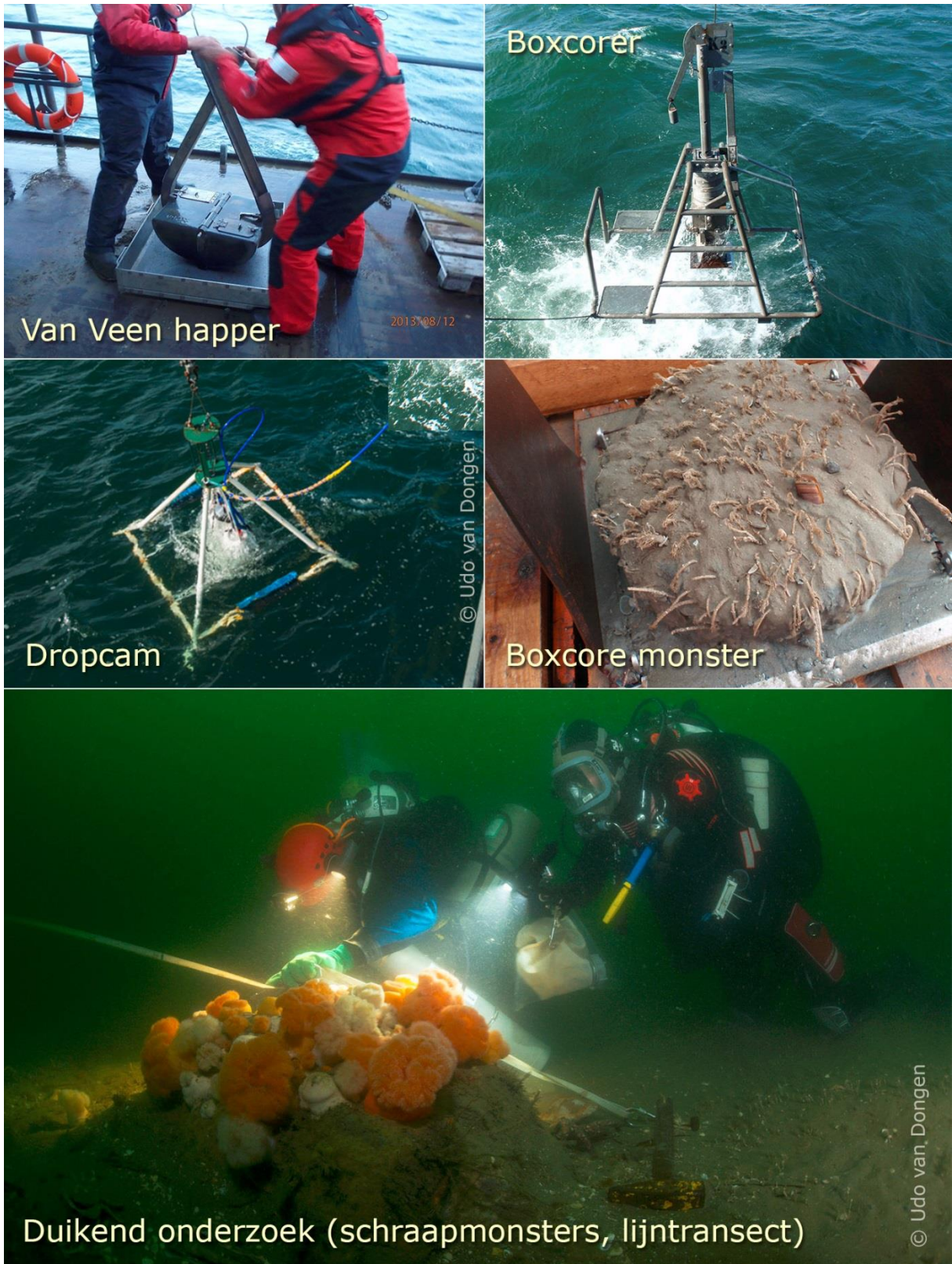
Figuur 3. Foto's van gebruikte bemonsteringstechnieken. Van boven naar beneden: Van Veen happer en Boxcore; Drop down camera (stereocamera in frame) en boxcore monster met Lanice conchilega . Onder: Duikers nemen een schraapmonster van een steen. Het lijntransect is zichtbaar tussen de steen en de duikers Foto's: IMARES en Udo van Dongen.
