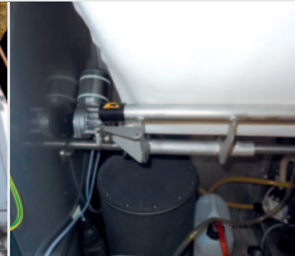
Het trilmecanisme onder de poederzak voorkomt brugvorming in het poederreservoir.
