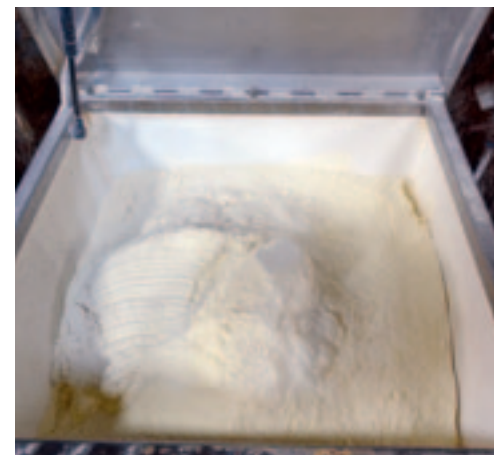
Het poederreservoir bevat maximaal 35 kilo melkpoeder.
