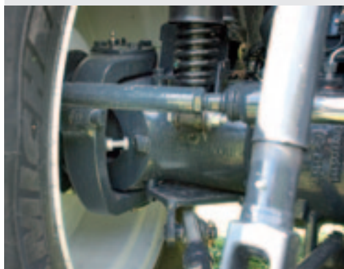
De uitslag van de achteras is maximaal 20 graden.
