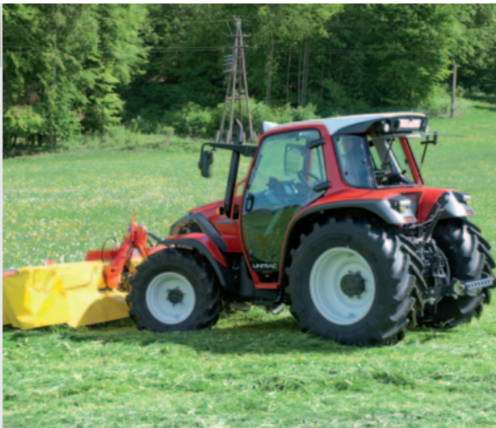
Lindner zet de Lintrac in de markt als een echte maaitrekker die door zijn lage zwaartepunt goed uit de voeten kan op bergachtig terrein. Ook op dijken en steile taluds zal de trekker zich goed thuisvoelen.
