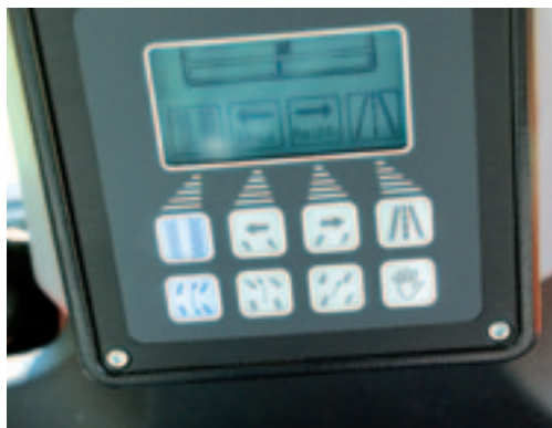
Op de rechtercabinestijl zijn de verschillende stuurmogelijkheden in te schakelen.
