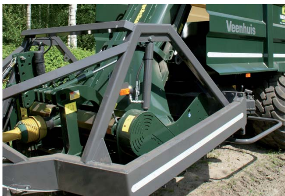
De Seppi M hangt via de driepuntsophanging pendelend in een apart subframe, dat aan het bestaande Jan Veenhuis-kipperframe is bevestigd.
