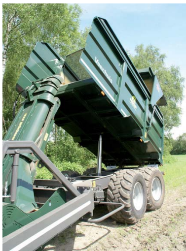
De kipper is zo kort mogelijk op de pijp gebouwd om hem ook achterin te kunnen vullen. Voor het kippen moet de blaaspomp even worden opgetrokken.
