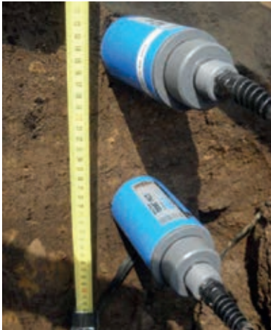
Afbeelding 4. Sensor die rechtstreeks op de klimaatcomputer kan worden aangesloten: Imko (Eijkelkamp).
