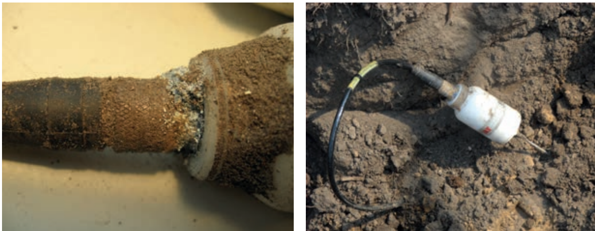
Afbeelding 1. De vochtsensoren die in het project gebruikt zijn: SM300, met rechts één van de structurele problemen corrosie van de connectoren, waardoor kortsluiting ontstond.
