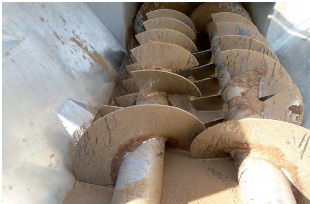
De schroef brengt de aangevoerde grondstof naar mengtanks stuurt.
