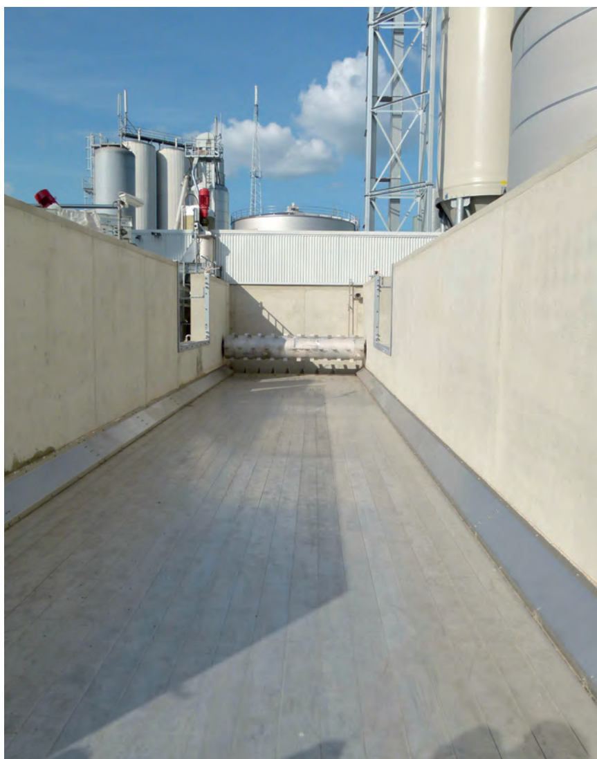
Door de walking floor kunnen vrachtwagens snel lossen en meteen vertrekken.
