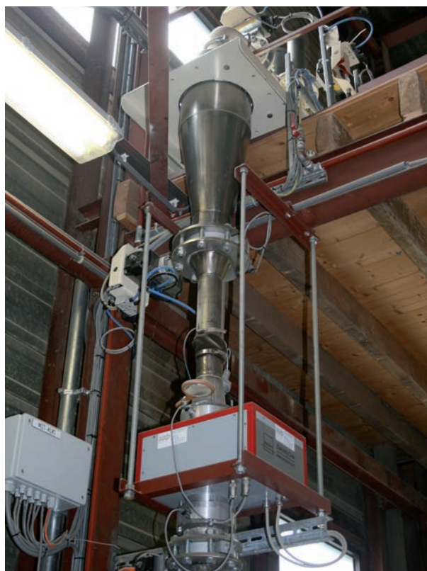
Met de PelletScan wordt met grote nauwkeurigheid het vochtpercentage en de dichtheid van het voer gemeten.
