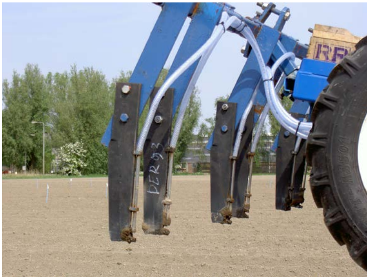
Figuur 1. Rijenbemester van NCOR , gebruikt voor rijenbemesting, 2 kouters per rug
