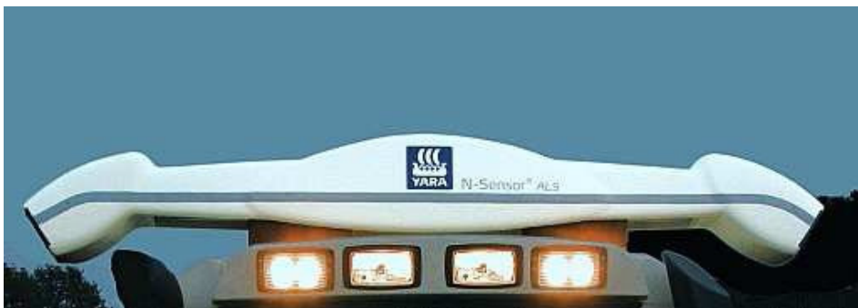
Figuur 1. Uitvoering reflectiemetingen met de Yara N-sensor
