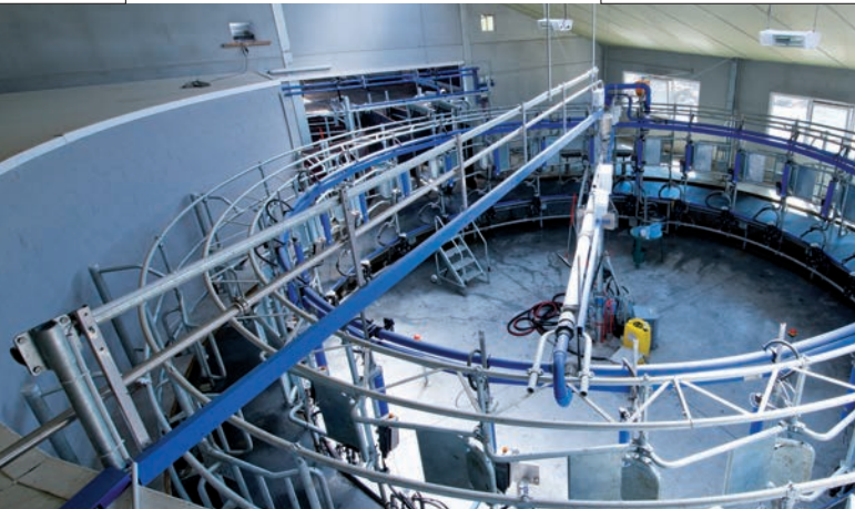
Een 24 standsrotor voorziet in snel melken
