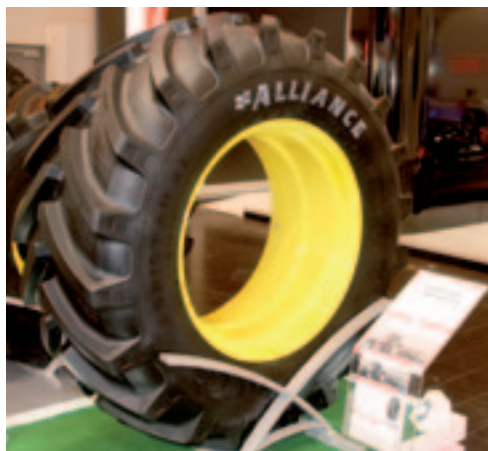
^ Grote trekkerband van Alliance Alliance presenteerde de 710/70R42 in de 378 Agristar XL-serie. Deze band, voor zware trekkers en maaidorsers heeft bij 65 km/h en 2,4 bar druk een draagvermogen van 6.900 kg. Bij 40 km/h en 1,6 bar is dat 5.960 kg.
