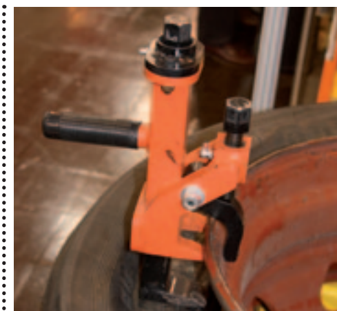
^ Bandenafnemer De AME-bandenafnemer heeft twee schroefspindels, die je verdraait met een luchtsleutel of een accuboormachine. Nadat de eenheid met de ene spindel op de rand van de velg is vastgeklemd duwt de tweede spindel de hiel van de velgrand. Een kind kan de was doen.
