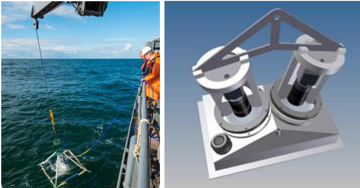
Figuur 3. Het camerasysteem gaat te water met behulp van een kraan.
