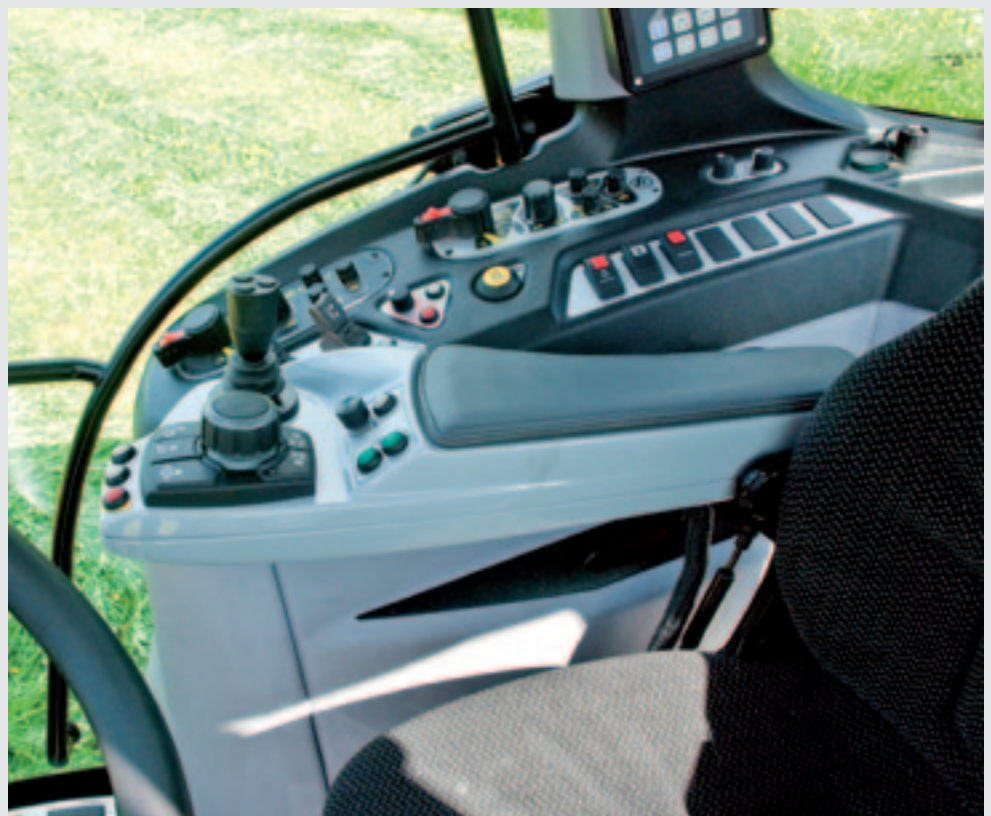
De bediening van de traploze bak gaat met een draai-drukknop op de rechterarmleuning. Met de joystick ernaast bedien je de hydraulische functies.
