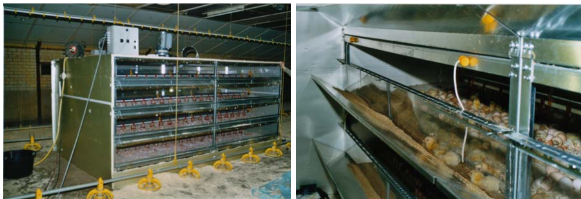
Figuur 4 Aanzicht (links) en detail (rechts) van het prototype van de Kuikenmoeder
