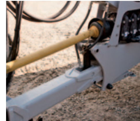
^ Disselbesturing Standaard wordt de Vega geleverd met disselbesturing. Op verzoek kun je de dissel ook met bovenaanspanning krijgen.
