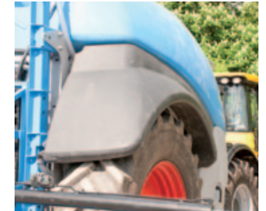
^ Schoonwatertanks De schoonwatertanks (2 keer 300 liter) hebben een plek gekregen in de spatborden van de spuitmachine.
