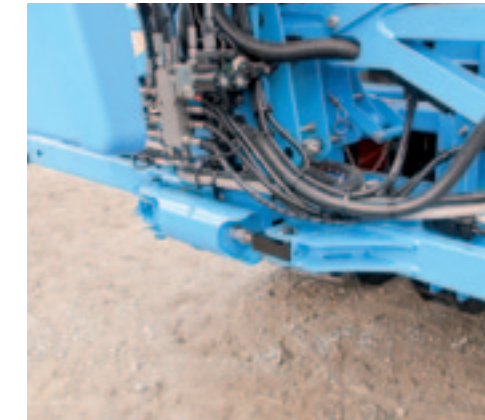
^ Anti-zwiepen De boomdelen links en rechts van de machine zijn niet aan elkaar gekoppeld en hebben beide een eigen demper.
