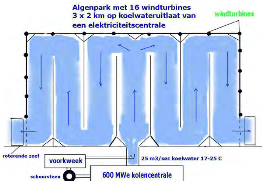
Figuur 11: Kolencentrale met koelwateruitlaat en kunstmatig 'eiland' voor de vorming van een algenkwekerij.
