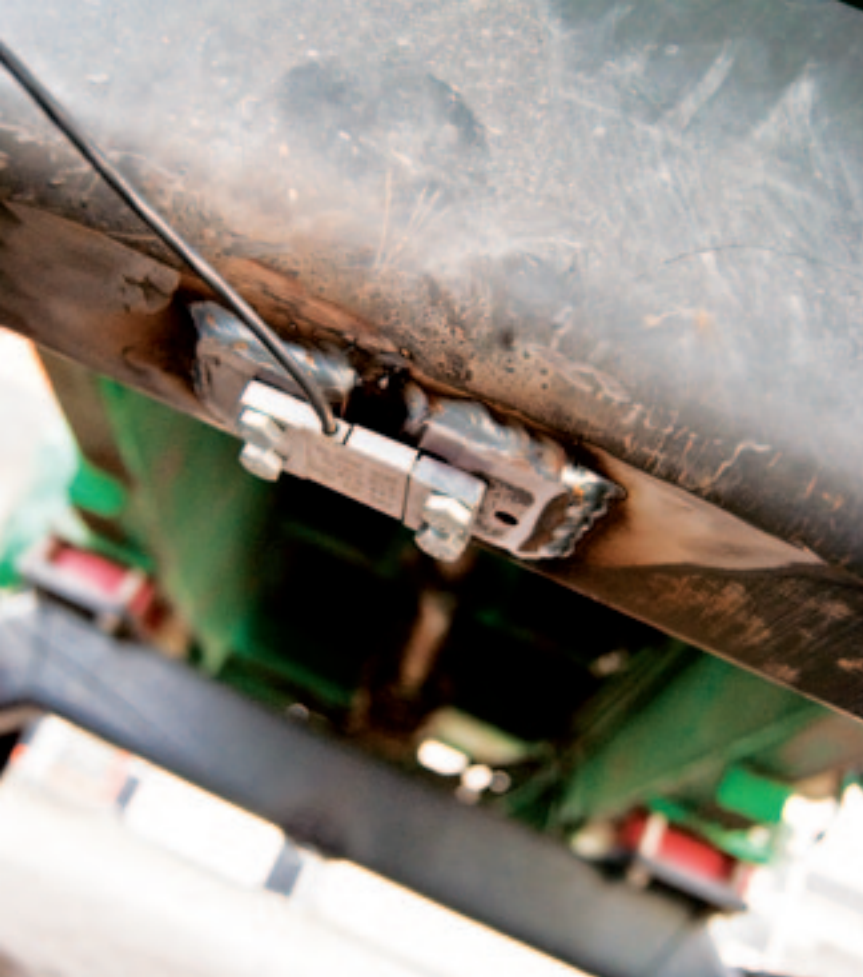
Met rekstroken wordt het doorbuigen van assen en dissel bepaald. Het weegstelsel wordt met gewichten ingeregeld.
