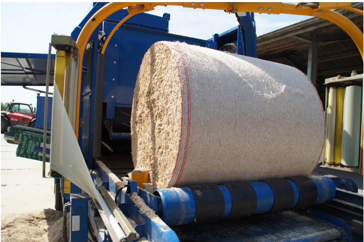
In een baal van 1.20 meter hoog en een diameter van 1.20 meter is gemiddeld 330 kilogram gehakselde Miscanthus geperst, met een Goweil LT Master balenpers.
