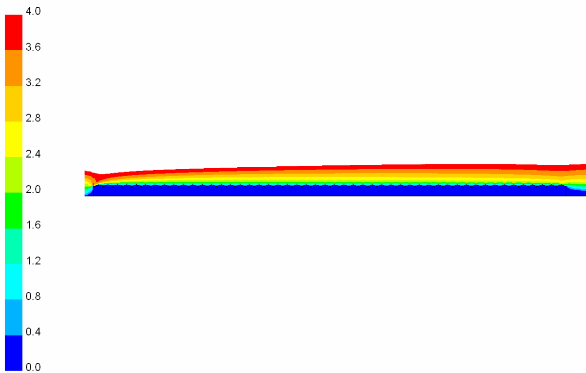
Figuur 7 Luchtsnelheid rond de kas met een poothoogte van 4 meter bij een windsnelheid van 4 \text{ m s}^{-1}
