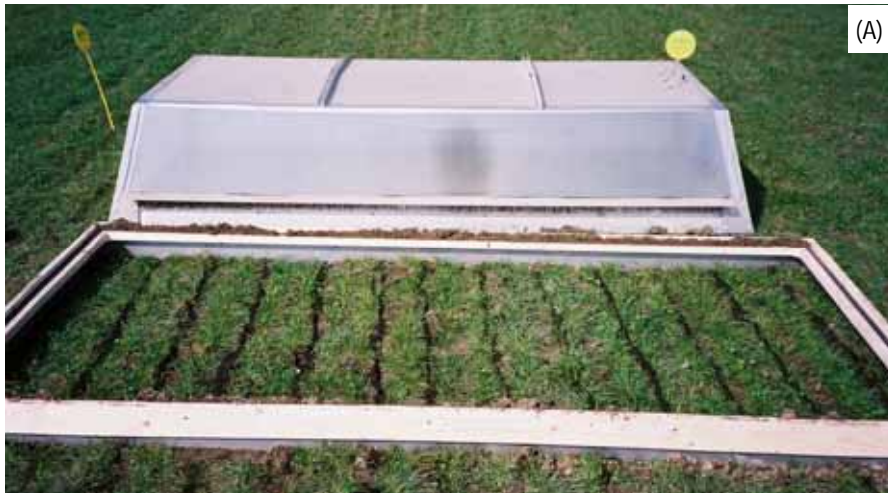
Figuur 4 Meetopstelling voor geur- en overige broeikasgasemissies. (A): Fluxkamer; (B): Fotoakoestische methode voor broeikasgas concentratiemetingen; (C); Geurvat voor geurconcentratiemetingen
