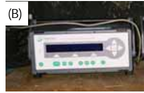
Figuur 4 Meetopstelling voor geur- en overige broeikasgasemissies. (A): Fluxkamer; (B): Fotoakoestische methode voor broeikasgas concentratiemetingen; (C); Geurvat voor geurconcentratiemetingen
