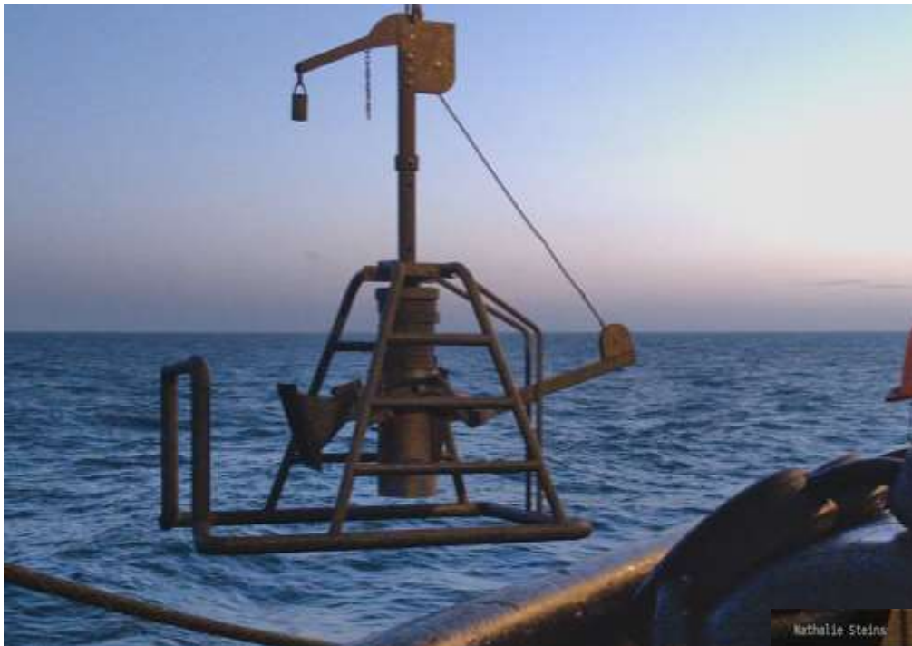
Foto 3: Boxcore uitzetten vanuit de zijkant van de Tridens Photo 3: Boxcore deployment from the side of the Tridens.
