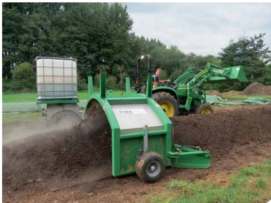
Het compostmengsel wordt opgezet in hopen van maximaal 3 meter breed en 1,5 meter hoog. De nadruk ligt op het luchtig opzetten.
