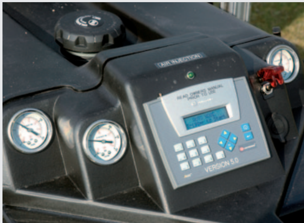
Het instellen en uitlezen van de machine gaat via een digitaal paneel met een klein schermje. Er zijn drukmeters voor de ketel, drukkracht op de pennen en de druk van de uitstromende lucht.
